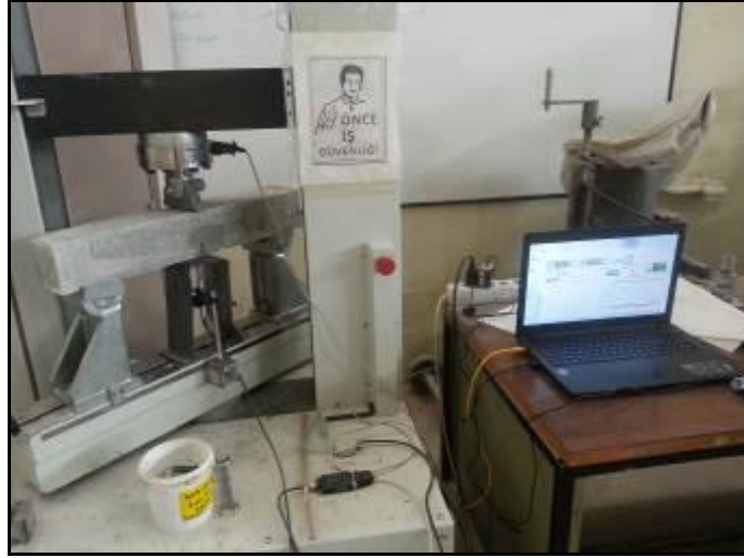
Şekil 3.5 Eğilme deneylerinin gerçekleştirildiği pres (Kişisel arşiv, 2017)
