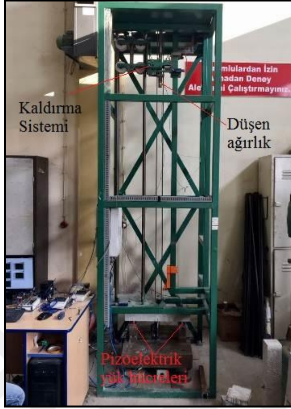
Şekil 3.8 112M262 numaralı proje ekibince tasarlanan ve üretilen darbe deney sistemi (Kişisel arşiv, 2017)
