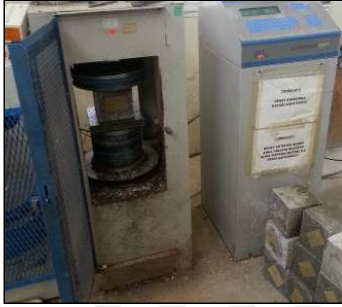
Şekil 3.4 Basınç deneylerinin gerçekleştirildiği pres (Kişisel arşiv, 2017)
