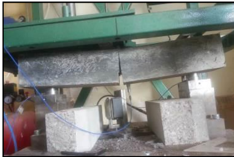
Şekil 3.9 Darbe deneyi sonrası kirişin durumu (Kişisel arşiv, 2017)
