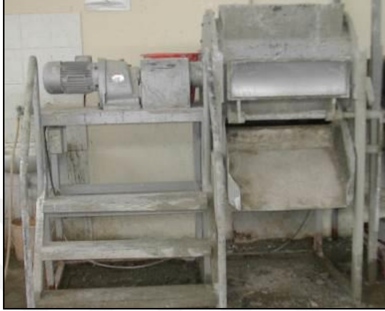
Şekil 3.3 Beton karışımlarının yapıldığı mikser (Kişisel arşiv, 2017)
