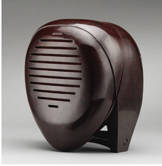
Resim 86: “Hemşire Radyo”. Japon heykeltıraş İsamu Noguchi tarafından, 1937 yılında tasarlanan bu cihaz, bebeğin odasında bir mikrofon ve stilize bir hemşire kafası biçiminde bir alıcıdan oluşmaktadır (URL, 77).
